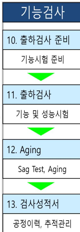
출하 검사 시 3상 DCV 제품을 당사 보유 Robot 시스템 (비선형부하)에 장착하여 24시간 Aging Test를 실시
